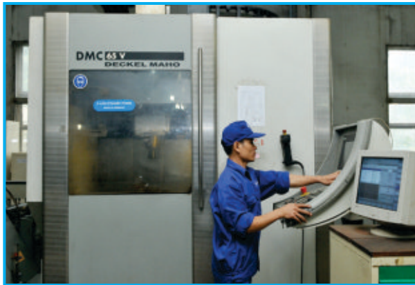
Trung tâm gia công 5 trục DMC 65V – Chế tạo nút cầu
